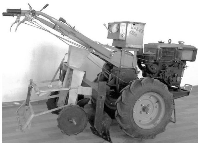
Рис. 3. Общий вид комбинированной машины KM-0,6-0,3 в агрегате с мотоблоком «Зирка»
