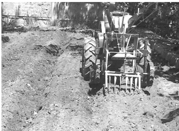
Рис. 3. а - МТА Мотоблок+КМ-0,6-0,3 при выполнении процессов нарезки гребней и посева семян лука; б - оценка качества работы агрегата
