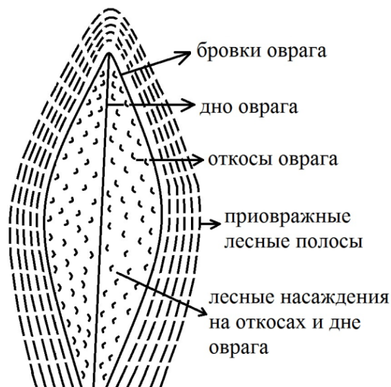
Рис. 6. Схема расположения приовражных и донных лесных насаждений
