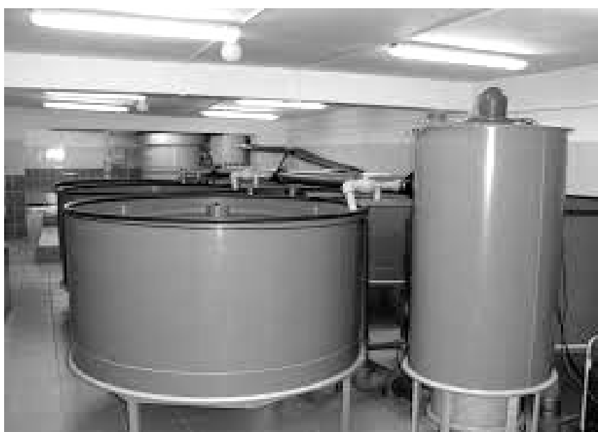
Рис. 2. Комплексная установка замкнутого водоснабжения (УЗВ)
