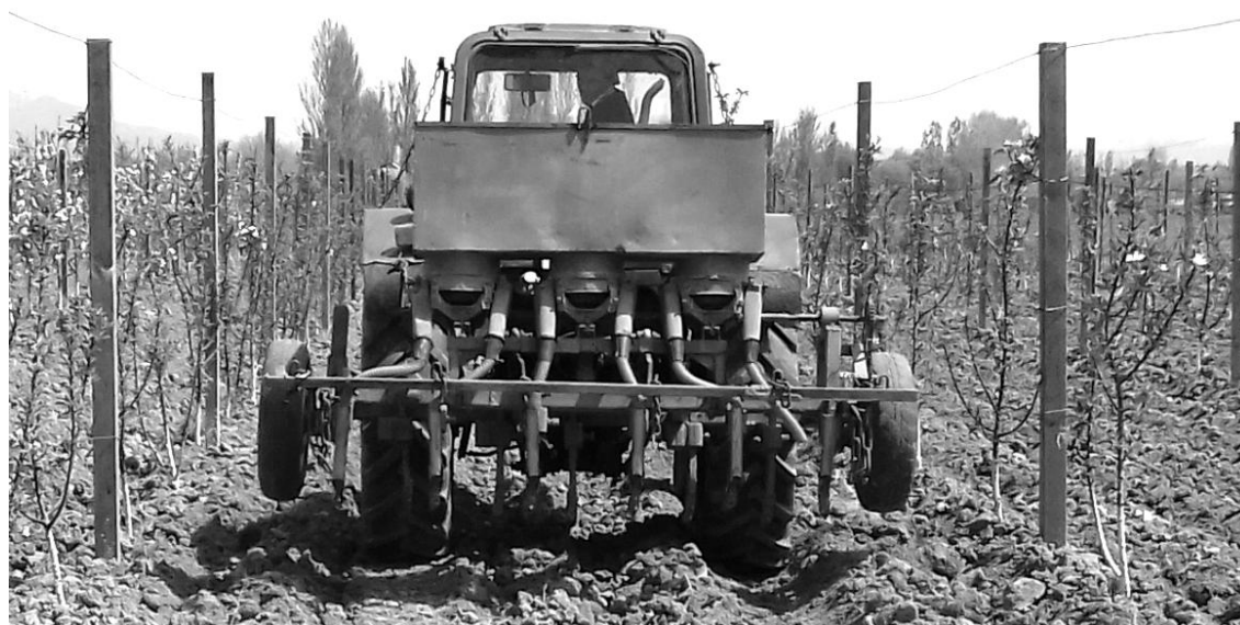
Рис. 3. Агрегат МТЗ-80+ЧКУ-2,0 в яблоневом саду
