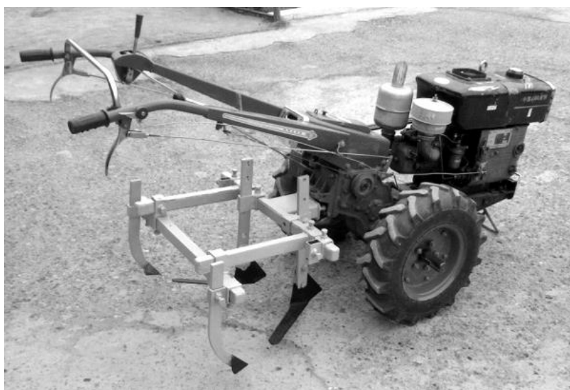
Расми 4. Намуди умумии култиватори КПМ-1 дар агрегат бо мотоблоки классии 0,2
