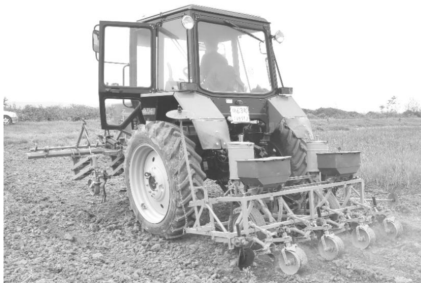
Рисунок 1. Общий вид универсальной комбинированной сеялки УКС-2,4 при выполнении технологического процесса
