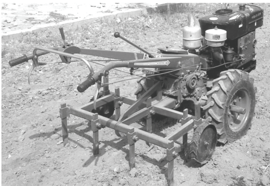
Расми 2. Намуди умумии култиватори ККЯ-1 дар агрегат бо мотоблоки Zirk WC80D (истеҳсоли Украина) ҳангоми иҷрои амалиёти технологияи коркарди болоии хок.
