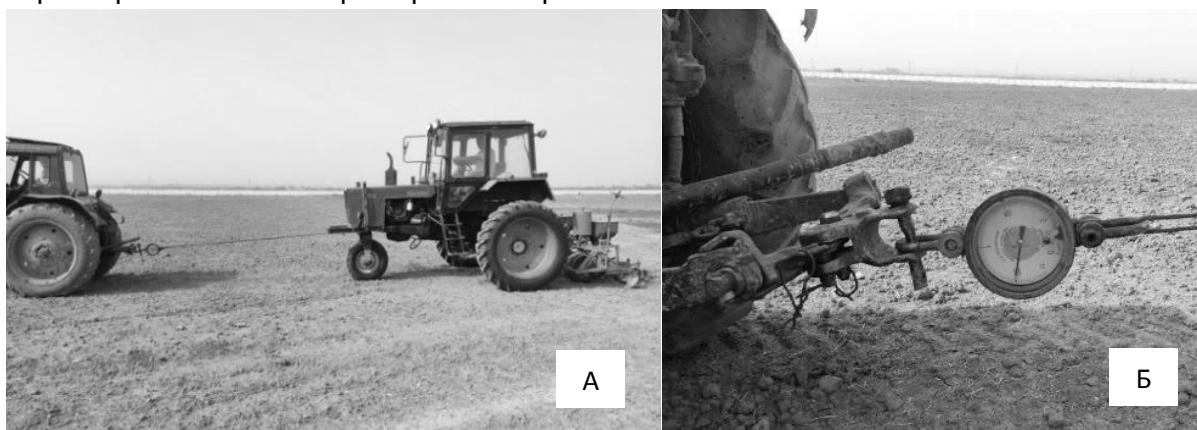
Рис. 4. А - Определение тягового сопротивления посевного агрегата методом буксирования; Б-динамометр ДПУ-2, установленный на буксирующей МТА
